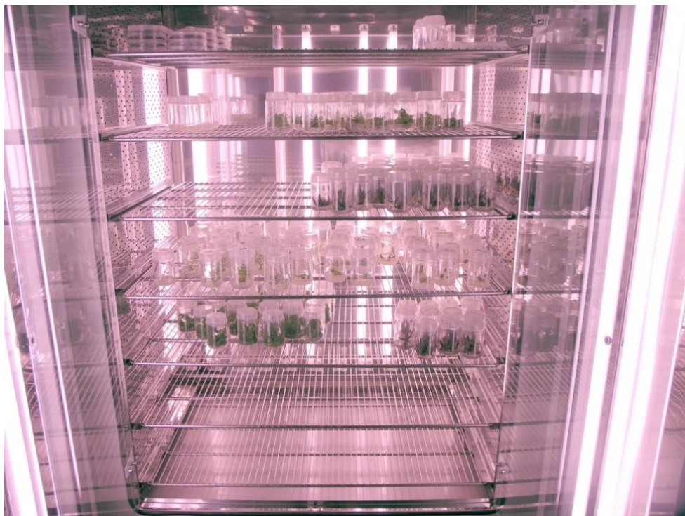
Slika 7: Rastna komora je posebni inkubator z natančno kontroliranimi dejavniki okolja kot so kakovost in količina svetlobe, dolžina osvetljevanja, temperatura in vlažnost.
