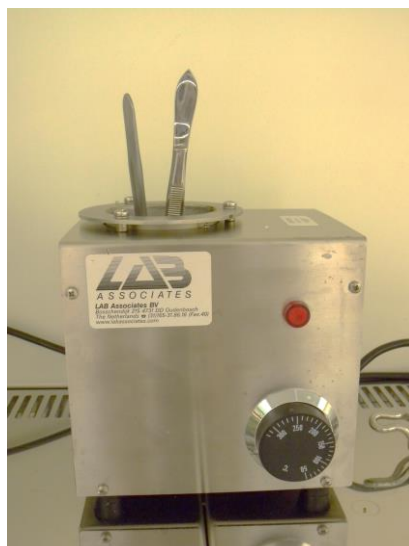
Slika 6: Sterilizator s steklenimi kroglicami. Orodje sterilizirate tako, da ga potisnete za 25 sekund v steklene kroglice, ogrete na 250 °C.
