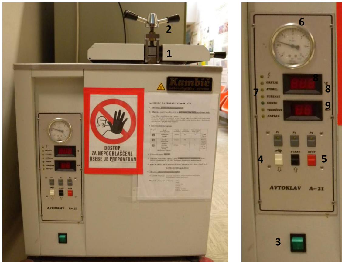
Slika 4: Osnovni deli parnega sterilizatorja (avtoklava) proizvajalca Kambič, tip A-21 V: 1 Pokrov, 2 ročka za privijanje pokrova, 3 glavno stikalo vklop/izklop, 4 polnjenje vode, bel gumb, 5 vklop sterilizacije – rdeč gumb, 6 manometer (do 5 barov), 7 potek sterilizacije, LED diode kažejo potek sterilizacije: vklop, gretje, sterilizacija, sušenje, konec, program tekočine, nastavitve parametrov, 8 temperatura, 9 čas sterilizacije.
